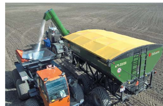
Загрузка разбрасывателя удобрений с помощью бункера-перегрузчика «Лилиани»
