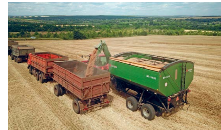
Бункер-перегрузчик «Лилиани». Выгрузка в автомашину.
