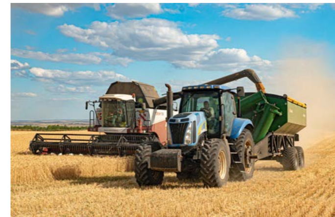
Бункер-перегрузчик «Лилиани» на уборке зерновых. Параллельная выгрузка комбайна.
