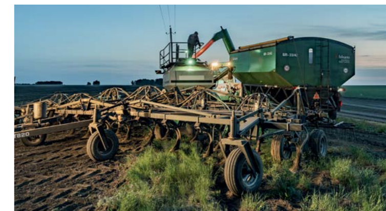
Загрузка посевного комплекса с помощью бункера-перегрузчика «Лилиани».
